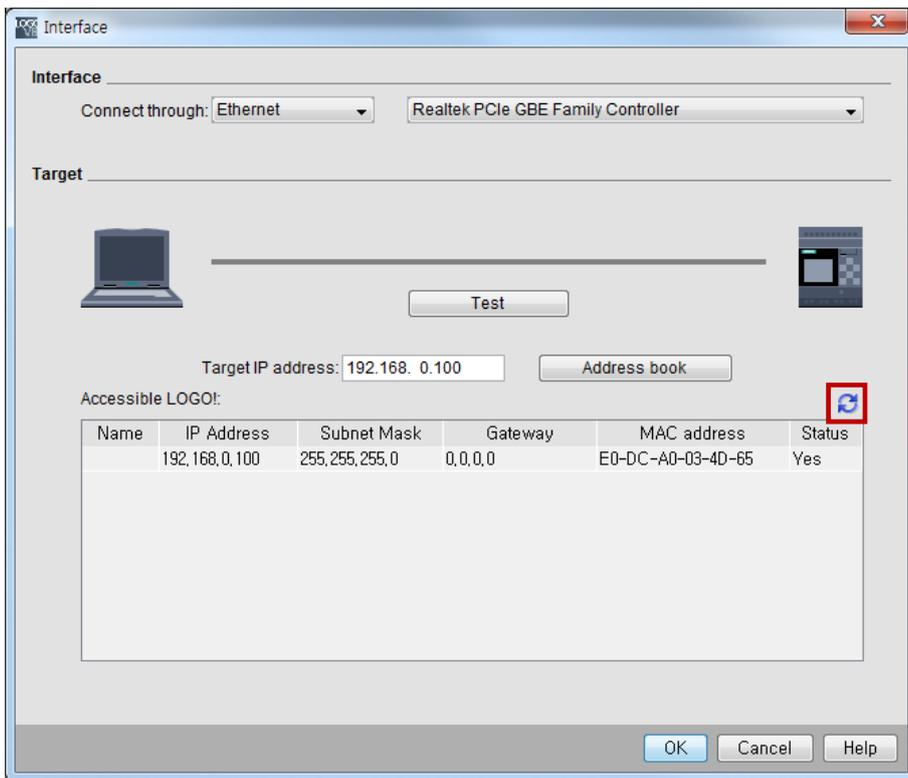
**Step 3.** Online settings > Assign IP Address > New IP settings 의 설정란에 새로 설정 할 모듈의 IP 주소를 입력한 후 "Assign IP address"를 클릭 합니다.
